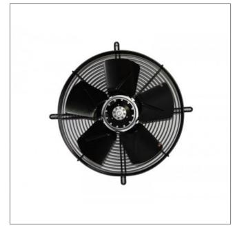
Le ventilateur hélicoïde sur grille **S4E330-AA06-07**, aspirant d'un seul côté possède une hélice 5 pales faucilles. Une grille de protection pour buse intégrale en acier plastifié noir et une plaque d'appui en tôle d'acier zinguée équipe ce ventilateur. La surface du rotor est peinte en noir.
