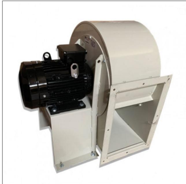
Ventilateur centrifuge simple ouïe **CB-2240-6T IE3 SODECA** avec turbine multipale avec aubes vers l'avant en tôle d'acier galvanisé et enveloppe en tôle d'acier.
